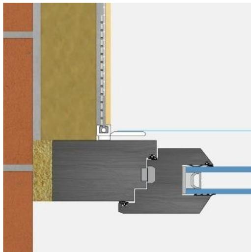
Perfil adesivo com rede fibra de vidro resistente e certificada segundo a **ETAG 004** (Documento que reúne as orientações para aprovação técnica europeia de Sistemas de Isolamento Térmico pelo Exterior - ETICS.)
