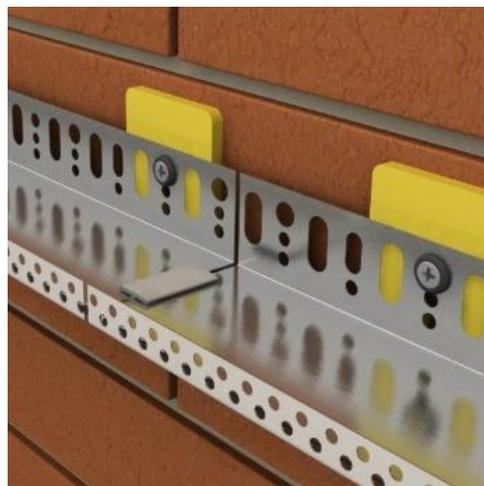
Espaçador em PVC, utilizado para fixação do perfil de arranque e para garantir o espaçamento do mesmo com o suporte. Ajuda a nivelar corretamente os painéis isolantes.
