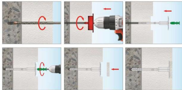
Acessório plástico para o corte rápido e limpo do painel isolante de EPS para posterior instalação das buchas de fixação mecânica.
