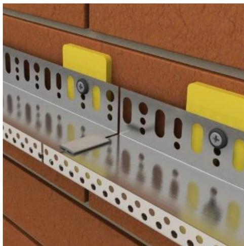
Parafuso em inox, utilizado para a fixação dos perfis de arranque do sistema de Isolamento Térmico pelo Exterior - ETICS.
