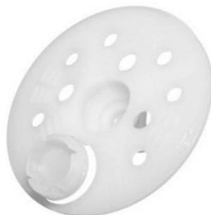
Disco com diâmetro de 60 mm para fixação do material isolante à estrutura, com tampa para evitar criação de pontes térmicas.
