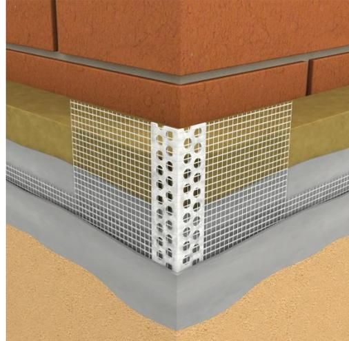
Perfil cantoneira em PVC com rede fibra de vidro resistente aos álcalis e certificada de acordo com ETAG 004, válido para qualquer espessura de argamassa, protege ângulos horizontais e verticais, ajudando a formar cantos perfeitos.
