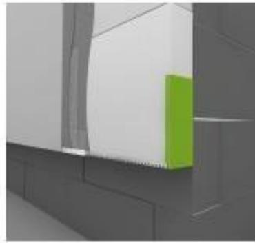
Perfil lateral de alumínio de 0,8 mm de espessura, é colocado nos limites verticais da área a ser coberta, facilitando o encerramento do sistema.
