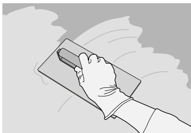
Aplicação do revestimento final.
