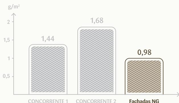
\*Ensaio comprovativo: Realizados no Centro de I&D da OMNOVA Solutions, a SYNTHOMER Company. Aqui são replicadas as condições verificadas em condensações nocturnas e medida a quantidade de surfactantes que se depositam à superfície do filme de tinta após 4h30 de exposição contínua.
